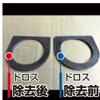
右端のギザギザ箇所がドロスです
